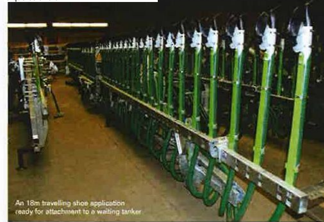
Una rampa con patines de 18 m lista para ser enganchada a una cuba pendiente
