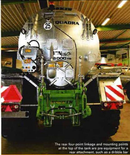
El elevador 4 puntos trasero y los puntos de montaje en la cumbre de la cuba son pre-equipamientos para un útil trasero, tal como una rampa de tubos
